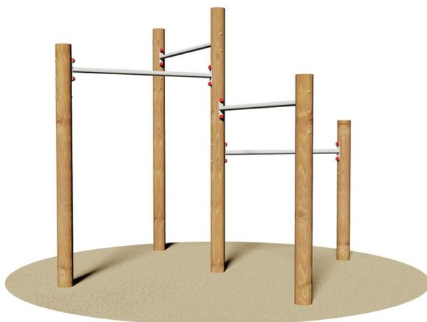
Certificato in conformità delle Norme Europee EN 1176 dall'Istituto Tedesco TÜV - SÜD. Realizzata con pali in legno di pino nordico impregnato in autoclave con sali atossici di sez. tonda Ø 12 cm. Elenco componenti: N°5 pali in legno disposti a croce di cui uno centrale e n°4 di altezze variabili. N°4 barre orizzontali in tubo tondo di acciaio zincato a caldo. Assemblaggio mediante bulloneria in acciaio zincato 8.8 e dadi autobloccanti. Elementi copridado a norma in nylon colorato.
